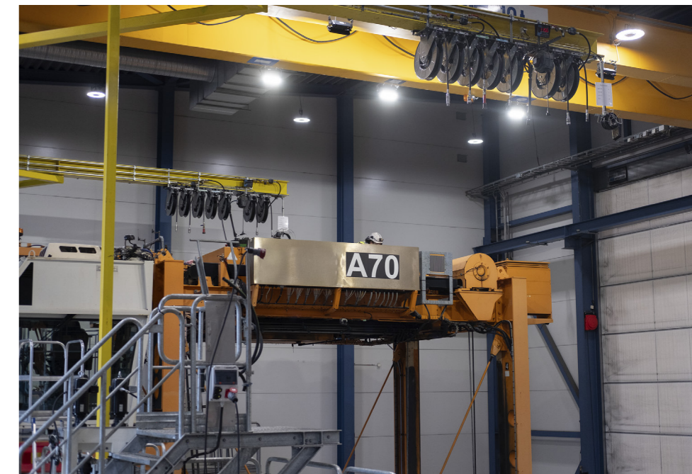
Grensletruckarna väger 67 ton och kan lyfta 50.
