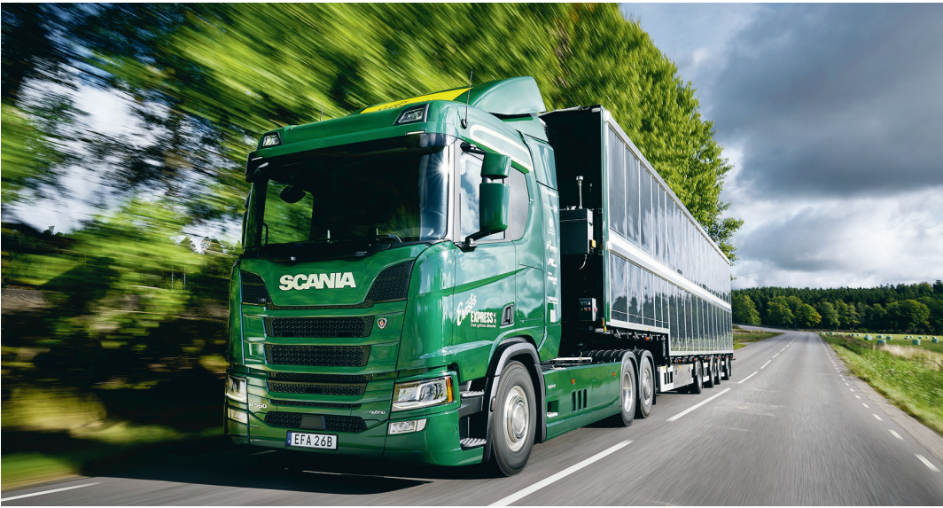
Lastbilen som delvis drivs på solceller är troligtvis den första i sitt slag.
