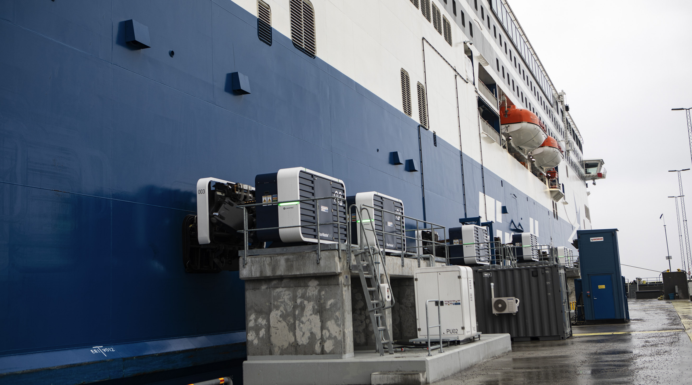
Frånskjut. På 15 sekunder är fartyget lösgjort från kajen och på väg mot Nådendal, Finland. Automatiserad förtöjning introducerades i Kapellskär i september 2023.
