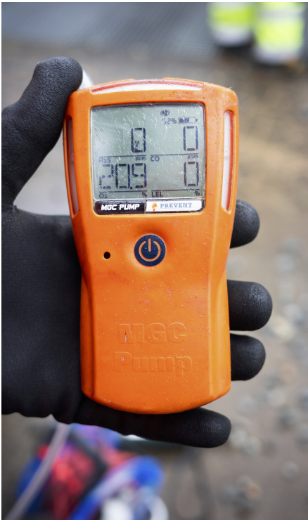
Gasmätaren upptäcker såväl brist på syre som flera brandfarliga gaser.
