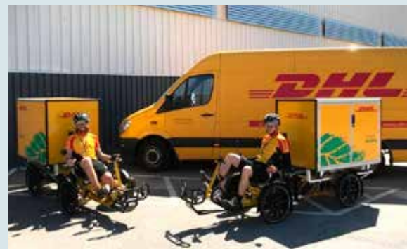
DHL Cubicycle är en fyrehjulig cykel med kapacitet för 150 kilo.
