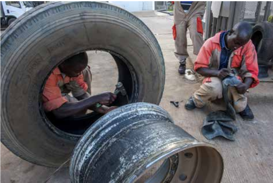
Punkteringen beror på att en stor bult har trängt in i hjulet. Men däckbytet är snart avklarat.
