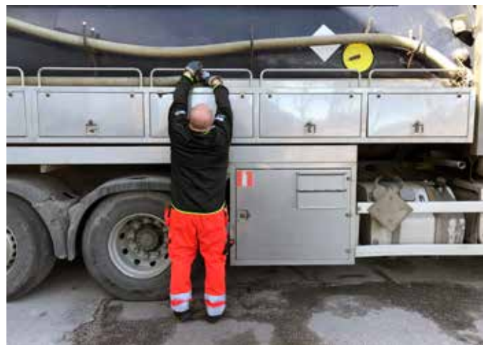
På spolbilens sida hänger den syrafasta slangen. Den byts ut några gånger i månaden.
