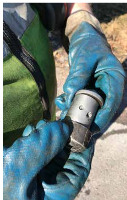
Ett specialmunstycke för spolslangen. Hålets vinkel gör att munstycket roterar och kan gräva sig fram där en vanlig spolslang inte räcker till.
